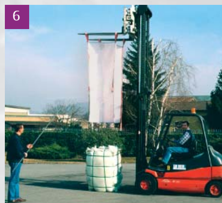
4/5/6- Sequenza sgancio rapido a distanza di sicurezza Sequence of quick, safe distance release
