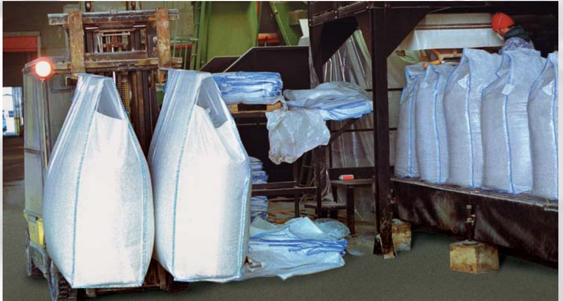
Movimentazione sacconi e impianto insaccaggio Big bags handling and filling plant
